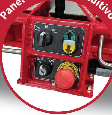
El panel de control es fácil de usar y ofrece un funcionamiento sencillo con ajustes de avance, retroceso y punto muerto, lo que permite un movimiento suave y controlado.
